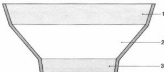
Bild 28 Trichterkorrekturen am Luftmengenmesser.
